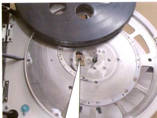
Cellule de synchronisation
